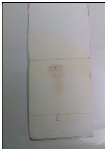
Figure 18 La plaque (CCM) après révélation sous UV et après révélation à la ninhydrine.
